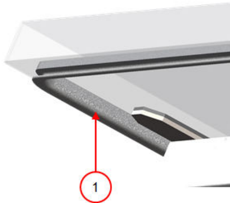
Abbildung 27: Austausch der Deckeldichtung
