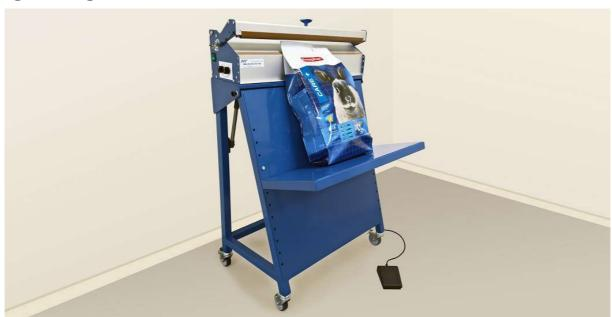
Robustes und fahrbares Gestell mit einem höhenverstellbaren Auflagetisch. Ein auf einen solchen Ständer montiertes SMS kann von horizontal auf vertikal umgestellt werden. Besonders geeignet zur einfachen Positionierung und zum Verschweißen von schweren Verpackungen. Belastbarkeit des Auflagetisches: bis 50 kg.
